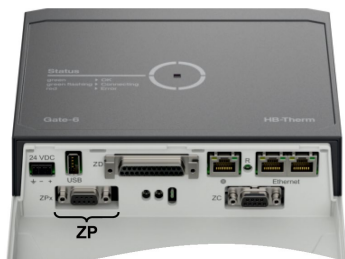
Abb. 1: Anschluss Profibus-DP (ZP) Gate-6
