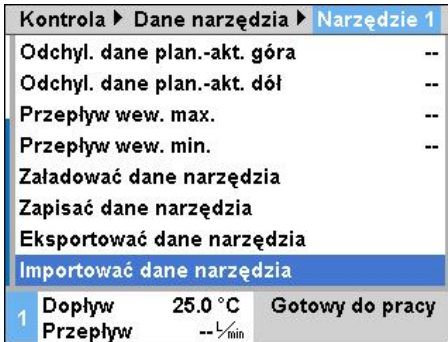
Rys. 83: Import parametrów narzędzia
