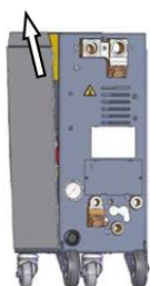
Fig. 90: Tragerea spre afară a tablei laterale
