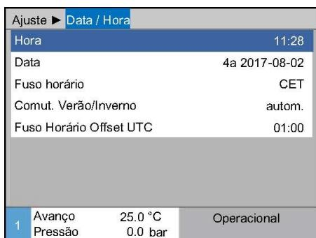
Fig. 63: Ajuste da data/hora
