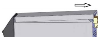
Fig. 88: Retire a chapa de cobertura
