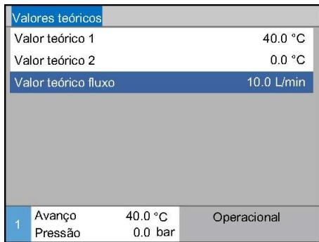
Fig. 56: Ajustar o valor teórico do fluxo
