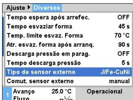
Fig. 35: Configuração do tipo de sensor externo
