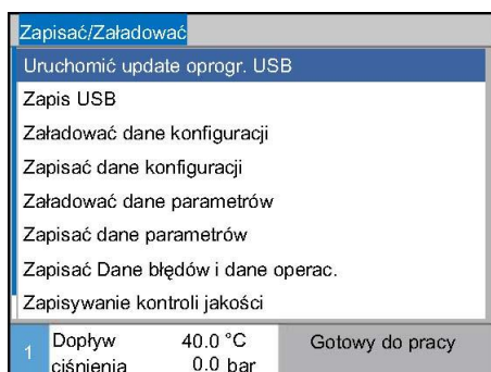
Rys. 92: Uruchomienie funkcji Update oprogram.
