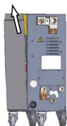
Fig. 90: Estrazione della lamiera laterale
