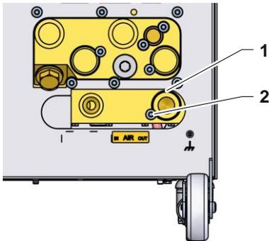
Abb. 12: Entleerung Druckluft Ausgang
