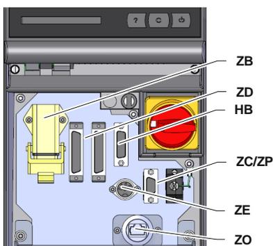
Abb. 19: Schnittstellen Einzelgerät
