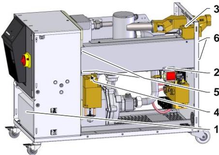
Abb. 97: Heizung 16 kW ausbauen
