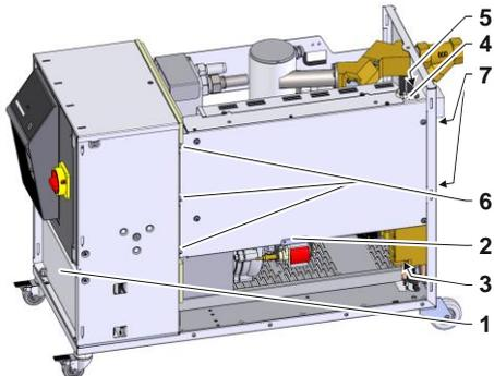
Abb. 98: Heizung 32 kW ausbauen
