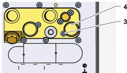
Abb. 11: Separater Anschluss Kühl- und Systemwasserausgang
