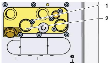
Abb. 10: Separater Anschluss Kühl- und Systemwassereingang
