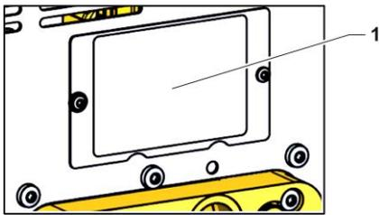
Abb. 93: Abdeckung Ventile
