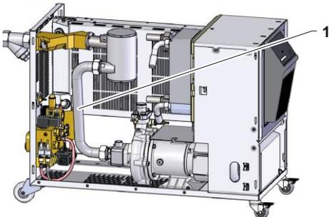
Abb. 94: Rohrverbindung ausbauen
