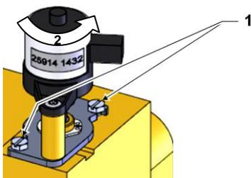
Abb. 95: Kühlventil 1 ausbauen
