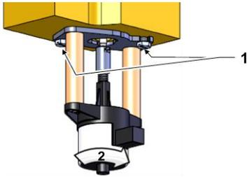
Abb. 96: Kühlventil 2 ausbauen
