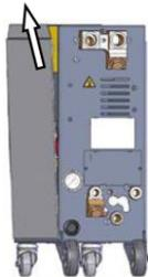
Abb. 90: Seitenblech herausziehen
