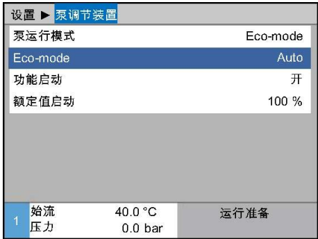
图48: 泵运行模式节能模式
