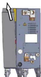
Fig. 85: Tragerea spre afară a tablei laterale
