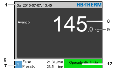
Fig. 20: Indicação básica aparelho operado como módulo
