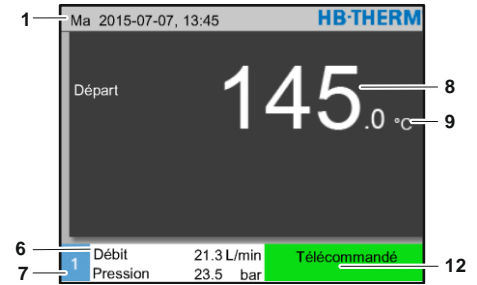
Fig. 20: Premier niveau d'affichage Appareil piloté comme module
