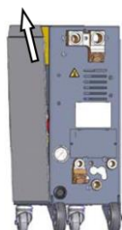
Fig. 85: Retirer la plaque latérale
