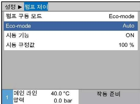
그림 50: 에코 모드 펌프 구동 모드
