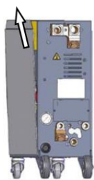
図87：サイドプレートを引き抜きます。
