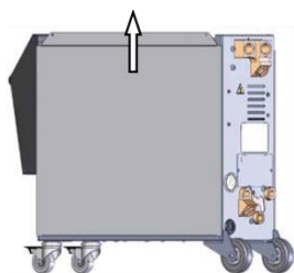
図86：サイドプレートを上へ引き上げます。
