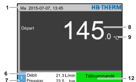
Fig. 22: Premier niveau d'affichage Appareil piloté comme module
