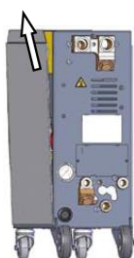
Fig. 90: Estrazione della lamiera laterale
