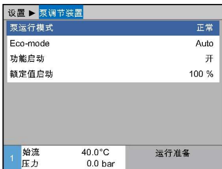
图64: 泵运行模式正常
