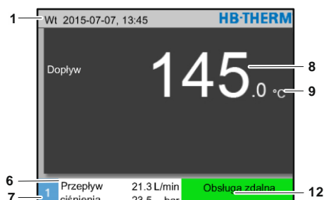
Rys. 24: Ekran główny – Obsługa urządzenia jako moduł
