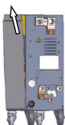
Fig. 92: Estrazione della lamiera laterale
