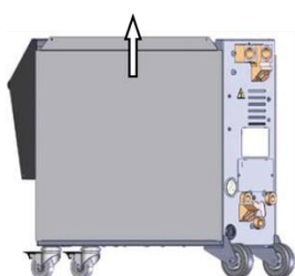
Fig. 91: Tirare verso l'alto la lamiera laterale
