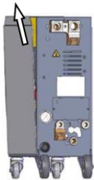
Fig. 92: Retirer la plaque latérale
