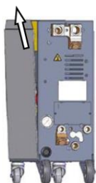
Рис. 87: Боковую панель вытащить
