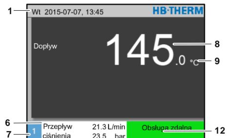
Rys. 20: Ekran główny – Obsługa urządzenia jako moduł
