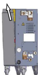
図87：サイドプレートを引き抜きます。
