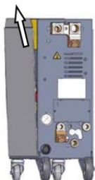
Фиг. 87: Изваждане на страничния панел
