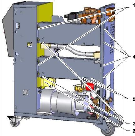
图96：拆卸加热装置
