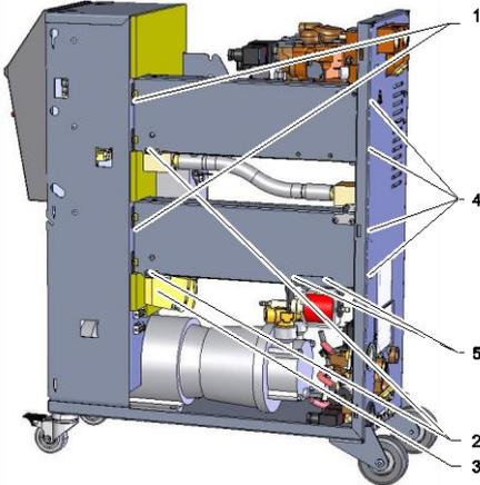
图96：拆卸加热装置
