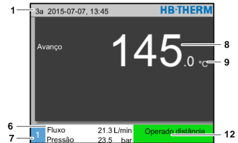
Fig. 24: Indicação básica aparelho operado como módulo
