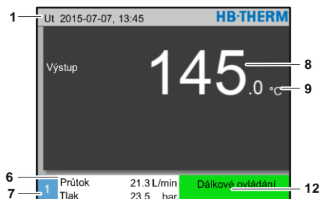
Obr. 24: Základní obrazovka - přístroj obsluhován jako modul
