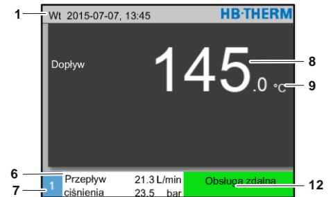
Rys. 22: Ekran główny – Obsługa urządzenia jako moduł
