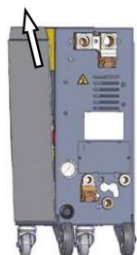
Rys. 89: Wyjąć blachę boczną
