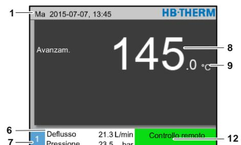
Fig. 22: Visualizzazione di base dell'apparecchio funzionante come modulo
