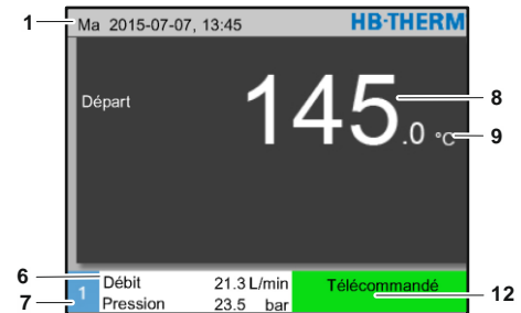
Fig. 22: Premier niveau d'affichage Appareil piloté comme module
