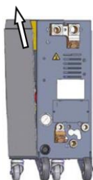
Fig. 89: Retirer la plaque latérale
