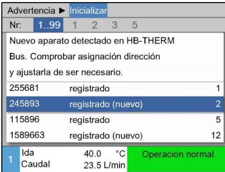
Fig. 26: Ajustar la dirección
