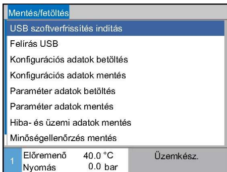
89. Ábra: Szoftverfrissítés elindítása
