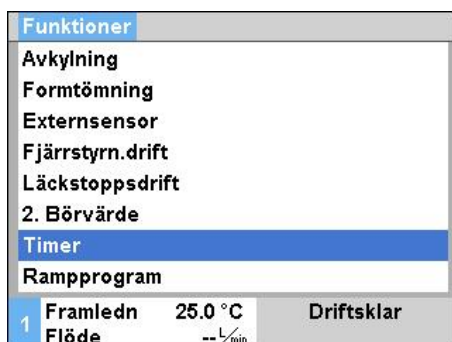
Bild 65: Aktivera resp. inaktivera brytarur
