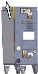
Afb. 89: Zijplaat eruit trekken
