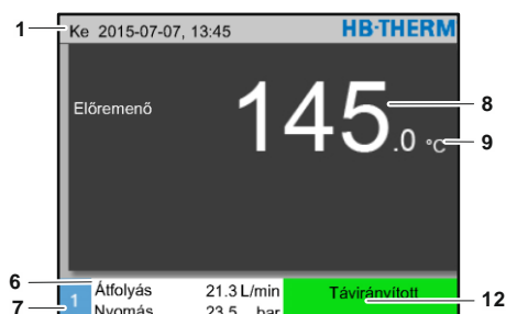
22. Ábra: Alapkijelző modulként vezérelt készülék
