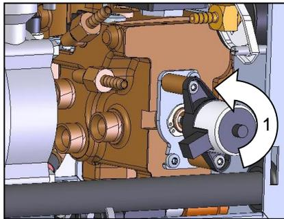
Abb. 93: Kühlventil 1 ausbauen
