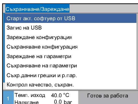
Фиг. 91: Стартиране на актуализацията на софтуера
