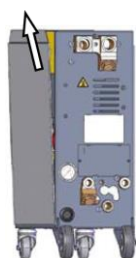
Fig. 91: Estrazione della lamiera laterale
