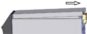
Fig. 89: Retirar la chapa de cubierta
