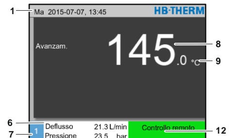
Fig. 24: Visualizzazione di base dell'apparecchio funzionante come modulo
