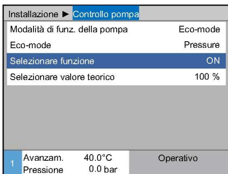
Fig. 73: Impostare la funzione avviamento.
