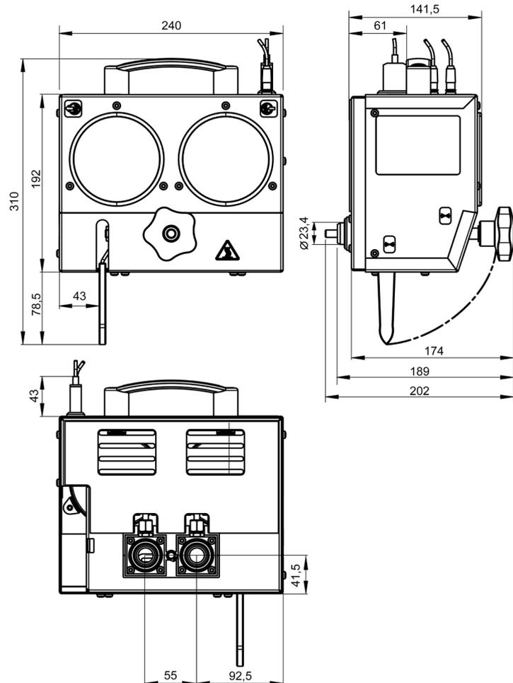
Abb. 1: Abmessungen HB-TP180/200-12
