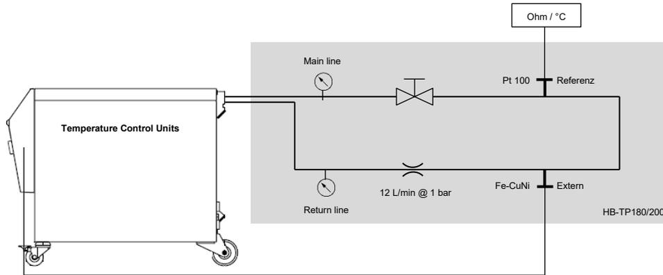
Abb. 6: Prüfprinzip
