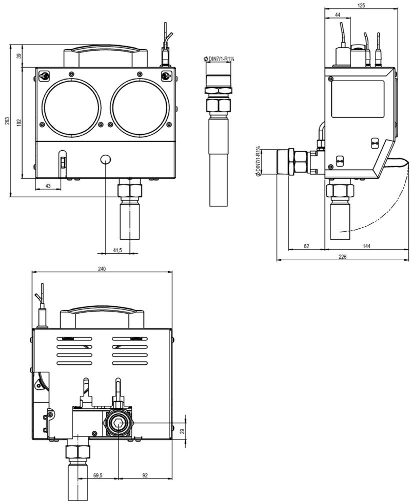
Abb. 3: Abmessungen HB-TP180-45
