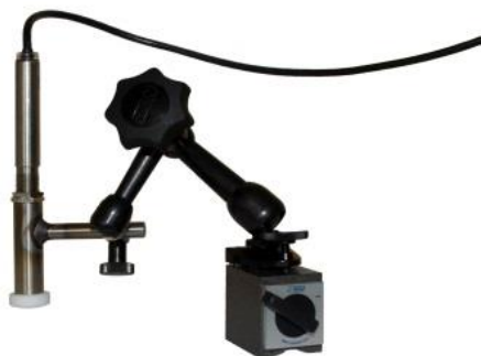
Sl. 2: Infrardeči senzor z magnetnim tokom in emisijsko nalepko za merjenje temperature lesketajočih se površin.
