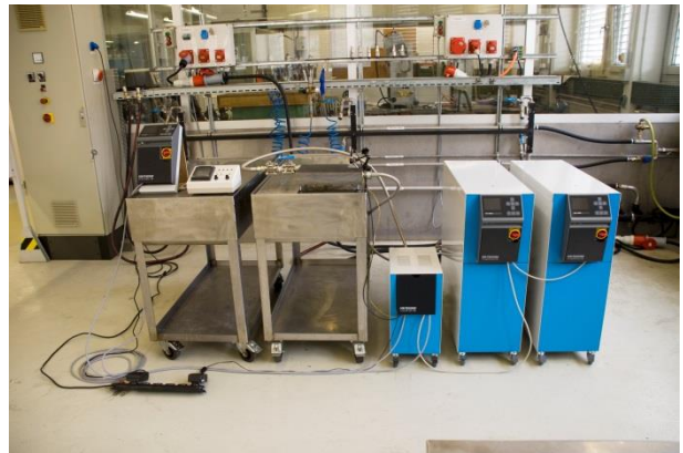
Sl. 1. Primer nameščene naprave Vario-5 (vzorčna zgradba s testnim orodjem in simulatorjem stroja)
