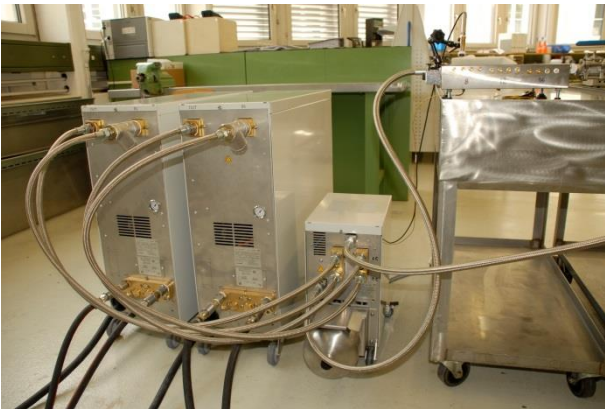
Obr. 1: Príklad nainštalovaného zariadenia Vario-5 (vzorová konštrukcia s testovacím nástrojom a simulátorom stroja)
