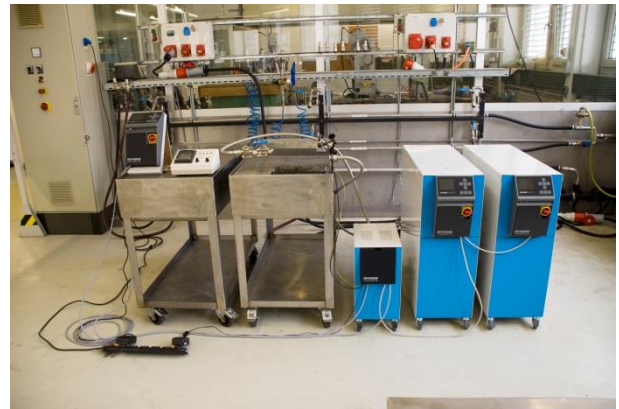
Obr. 1: Príklad nainštalovaného zariadenia Vario-5 (vzorová konštrukcia s testovacím nástrojom a simulátorom stroja)
