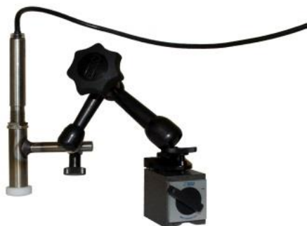
Obr. 2: Infračervený senzor s magnetickým tokom a emisnou nálepkou na meranie teploty lesklých povrchov
