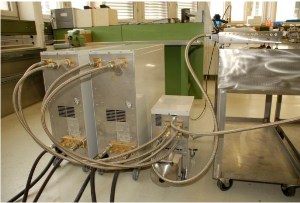
Рис. 1: Пример смонтированной установки Vario-6 (образец с тестовым инструментом и имитатором машины)
