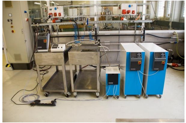
Fig. 1: Exemplu de instalate Vario-5 montată (mostră de structură cu matriță de test și simulator de mașină)
