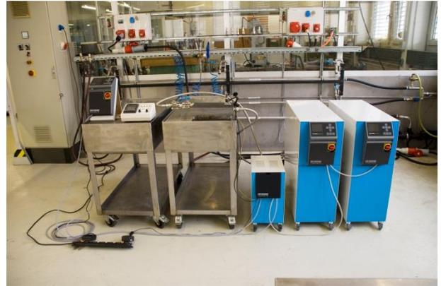
*Fig. 1. Exemplo de uma instalação Vario-5 instalada (montagem de amostra com ferramentas de teste e simulador de máquina)*
