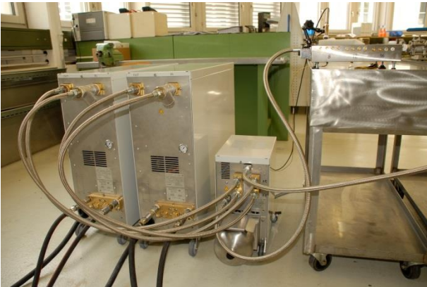
Rys. 1. Przykład zainstalowanego urządzenia Vario-5 (przykładowa konstrukcja z narzędziem testowym i symulatorem maszyny)
