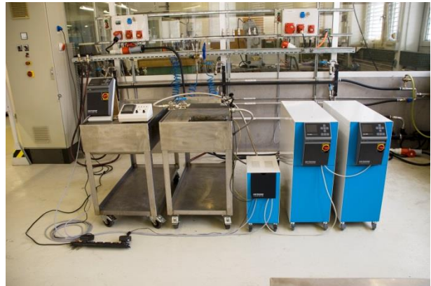
Rys. 1. Przykład zainstalowanego urządzenia Vario-5 (przykładowa konstrukcja z narzędziem testowym i symulatorem maszyny)
