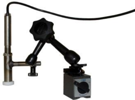
図 2: 光沢のある表面の温度測定用の、マグネット台座と揮発性接着剤が付いた赤外線センサー
