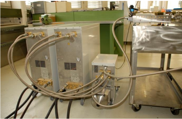
図 1.設置されたVario-5システムの例 (テストツールと機械シミュレーターを備えたサンプル構成)
