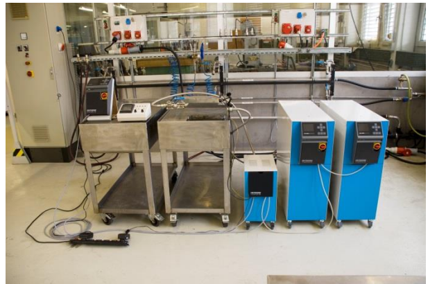
Fig. 1. Esempio di un impianto Vario-5 installato (esempio di installazione con utensile di prova e simulatore della macchina)
