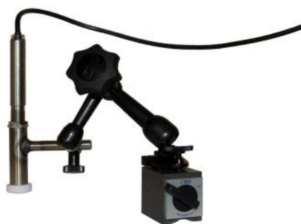
Fig. 2: Sensore a infrarossi con piede magnetico e adesivo emissioni per la misurazione della temperatura su superfici lucide
