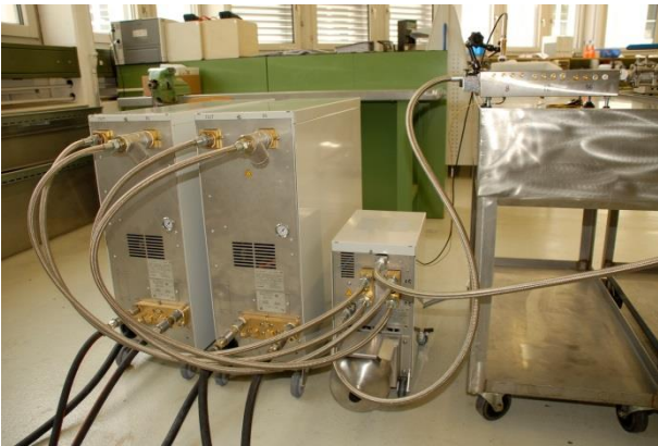
Fig. 1. Esempio di un impianto Vario-5 installato (esempio di installazione con utensile di prova e simulatore della macchina)
