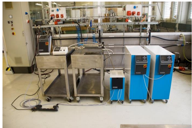
Fig. 1. Exemple d'une installation Vario-5 montée (mise en place type avec outil d'essai et simulateur de machine)
