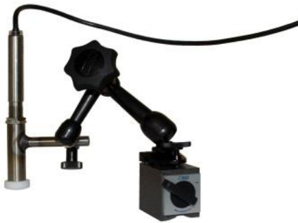
Fig. 2 : Capteur infrarouge avec pied magnétique et colle d'émission pour la mesure des températures de surfaces brillantes
