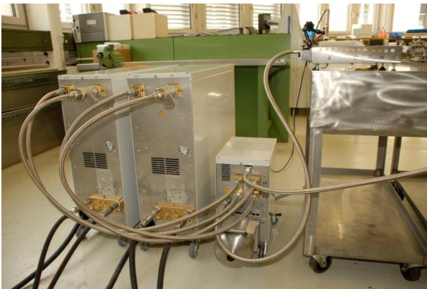
Fig. 1. Exemple d'une installation Vario-5 montée (mise en place type avec outil d'essai et simulateur de machine)
