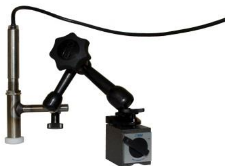
Fig. 2: Sensor de infrarrojos con base magnética y fijador de emisiones para la medición de la temperatura de superficies brillantes
