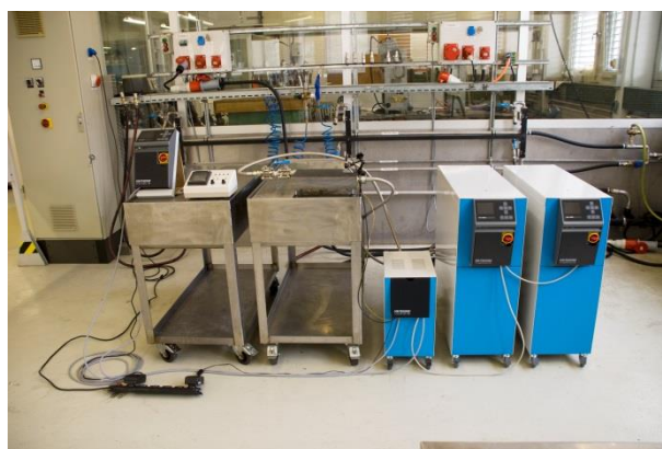
Fig. 1: Ejemplo de una instalación Vario-5 instalada (estructura de muestra con herramienta de prueba y simulador de la máquina)
