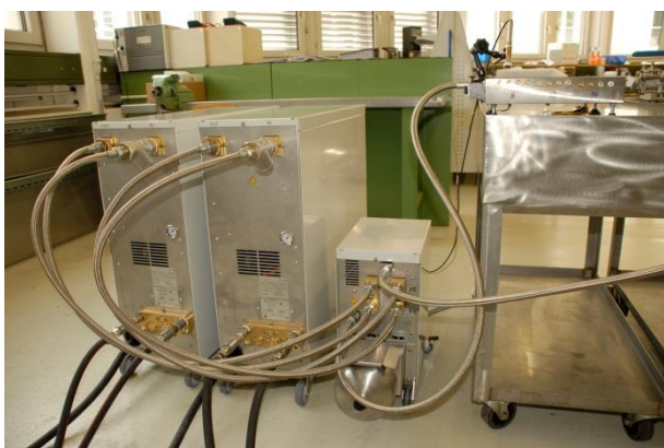
Fig. 1: Ejemplo de una instalación Vario-5 instalada (estructura de muestra con herramienta de prueba y simulador de la máquina)
